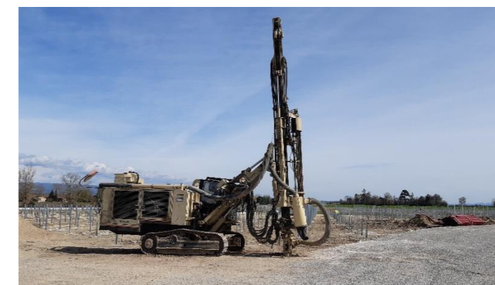
Figure 7 : Exemple d'une foreuse pour pieux battus (Source : SOLER IDE)
